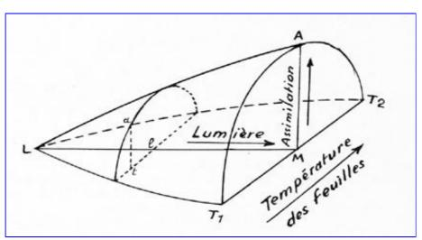
Une situation microclimatique quelconque (lumière l, température t de la figure 1) se traduit par une assimilation carbonée déterminée : t. a. Quand il n'y a plus de lumière, en L, toute la photosynthèse est arrêtée. Seule alors fonctionne la respiration (qui serait représentée au-dessous du plan L-T1-T2 de la fig. 1).
